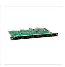
La VM7824 est une carte d'entrée HDMI True 4K qui fonctionne avec un commutateur matriciel modulaire ATEN pour offrir un moyen facile d'acheminer 4 sources audio/vidéo HDMI vers 4 affichages avec une prise en charge des images en haute définition True 4K. En plus de l'interface HDMI qui transporte les signaux A/V numériques, la VM7824 est équipée de 4 ports d'entrée audio stéréo qui permettent l'intégration audio stéréo.
