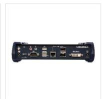
Le KE6920 est un système d'extension sur IP de hautes performances qui comprend un émetteur (KE6920T) et un récepteur (KE6920R). L'émetteur se connecte à un ordinateur pour fournir les données de l'ordinateur au récepteur afin d'offrir un accès collectif à la console depuis un emplacement distant ou séparé.
