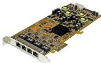
Le modèle NIC PoE 4 ports ST4000PEXPSE vous permet d'ajouter quatre ports Gigabit Power over Ethernet au moyen d'un seul slot PCI Express. Chaque port peut fournir jusqu'à 25,5 W, combinant les données de réseau et l'alimentation en un seul câble Ethernet pour réduire l'enchevêtrement et faciliter l'utilisation à distance de périphériques PoE.
