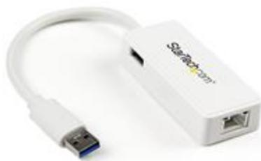
L'adaptateur USB 3.0 vers Gigabit Ethernet USB31000SPTW vous permet d'ajouter un port réseau Gigabit à votre ordinateur MacBook® ou Ultrabook™; à l'aide d'un port USB 3.0. De plus, il comprend un port USB Pass-Through 3.0 intégré qui garde votre port USB libre pour d'autres périphériques. Le port RJ45 prend en charge l'Ethernet 10/100/1000 Mb/s et offre une compatibilité totale avec les normes IEEE 802.3i/u/ab.
