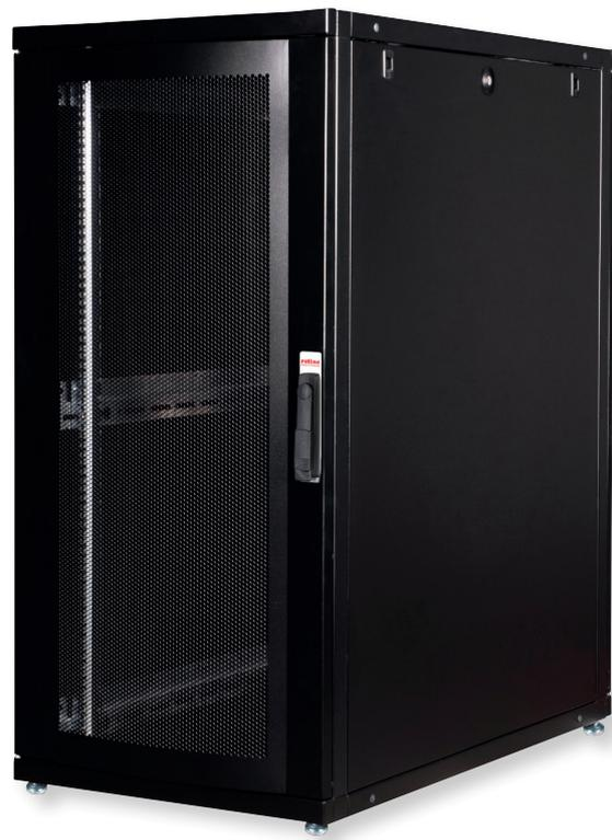
Les armoires serveurs de la série ROLINE Pro ont été spécialement conçues pour un câblage réseau confortable et flexible. Chaque armoire se compose d'une construction robuste en acier d'une épaisseur de matériau allant jusqu'à 2,0 mm. La charnière de la porte peut également être changée. La construction complète est démontable, ce qui permet de désassembler entièrement les armoires en cas de besoin.
